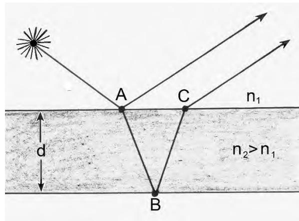
Reflexion von Licht an einer Seifenlamelle für schrägen Einfall des Lichts. Das Beispiel ist für senkrechten Einfall des Lichts.
