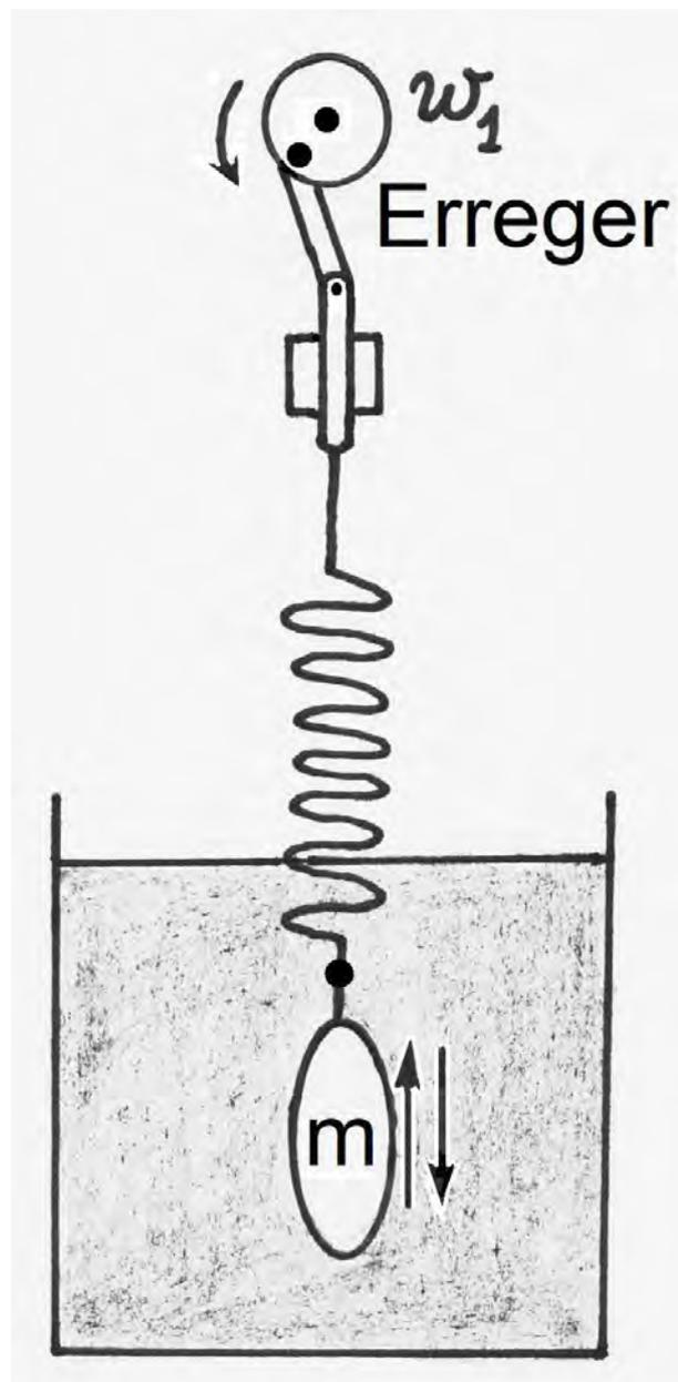
Erzwungene Schwingung einer Federpendels in einer viskosen Flüssigkeit.
